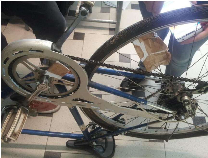
Fig.5. Determinazione del periodo di rotazione di una ruota in relazione ai denti dei pignoni. I cartoncini vengono utilizzati come indicatori per il sensore di prossimità di due smartphone posti sulla ruota posteriore e sul pignone del pedale.
