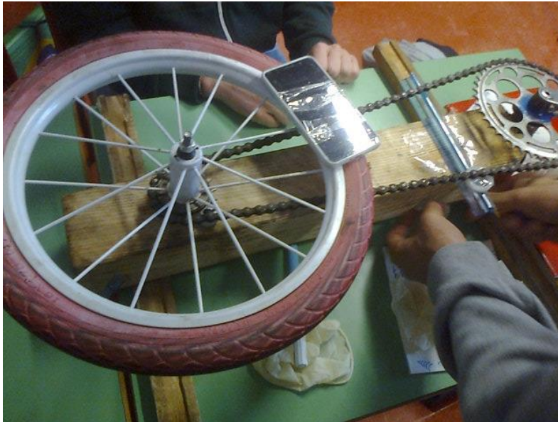
Fig.6. Misura della decelerazione di una ruota e studio del momento di attrito.
