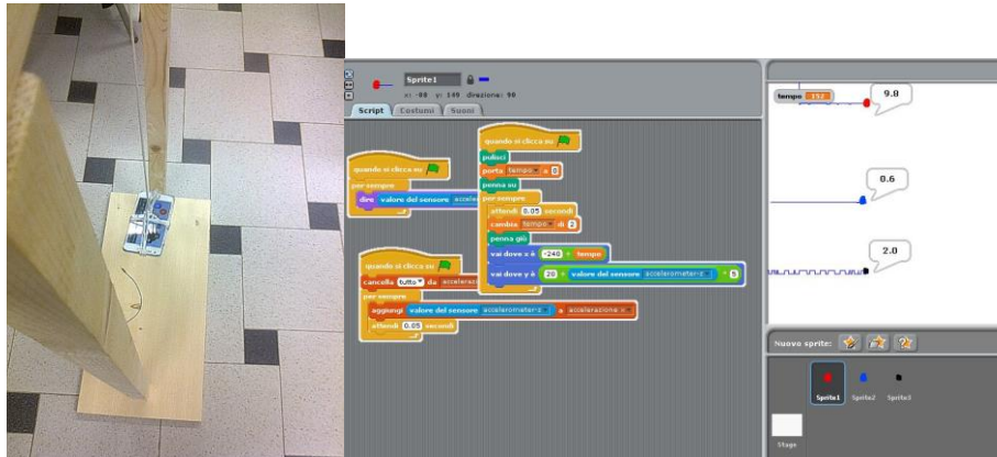
Fig.4. Studio delle componenti delle accelerazioni di uno smartphone, posto in oscillazione, attaccato ad una corda.
