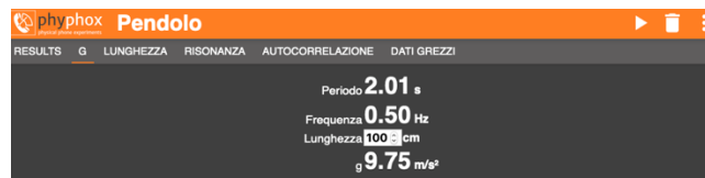
Fig. 1. Inserendo la misura della lunghezza, Phyphox restituisce il valore di g
