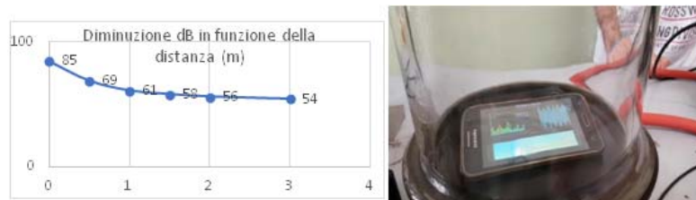
Fig. 3. Diminuzione dell'intensità sonora in funzione della distanza e utilizzo di uno smartphone come sorgente sonora nel vuoto.
