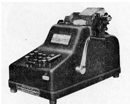
**Fig. 5.** *Addizionatrice manuale a tastiera ridotta*
